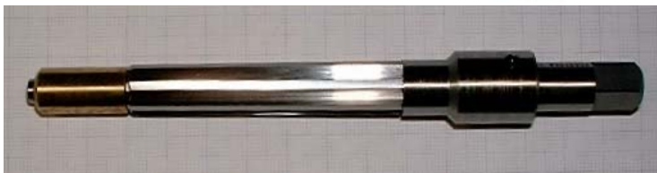
Tiefenanschlag, der in der Gürtelausfräsung anschlägt
