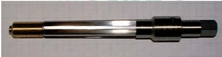
Tiefenanschlag, der in der Gürtelausfräsung anschlägt
